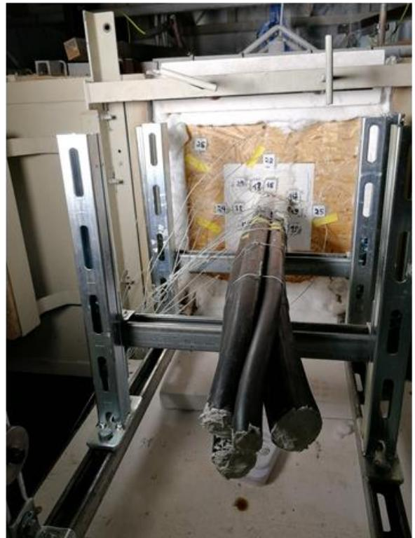
**Abbildung 24:** v. l .n. r. Brandschutzkabelmanschette CFS-CC, Brandschutzmanschette CP 644, Brandschutzrohrschale Conlit 150 U und Brandschutzbandage CFS-B, Platten-Weichschott mit Brandschutzbeschichtung CP 673 (jeweils in OSB-Modul)
