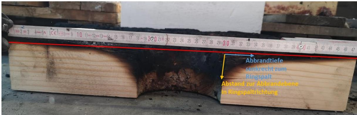
**Abbildung 52: Abbrandtrichter des Ringspalts mit Richtungsdefinition**
