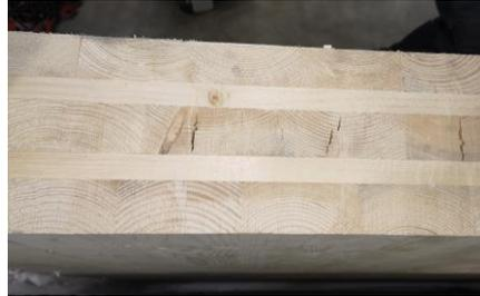
Abbildung 38: Schichtaufbau BSP-Wand
