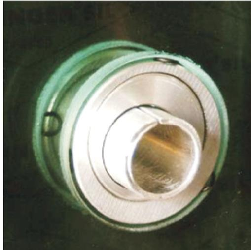
Bild 1. Zwischenschicht aus Mörtel zur Schaffung von Quasi-Duktilitäten
