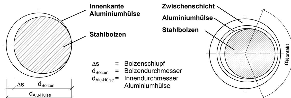
**Bild 5.49: Schlupf  $\Delta s$  zwischen Stahlbolzen und Aluminiumhülse (links), Kontaktwinkel  $\alpha_{\text{Kontakt}} < 180^\circ$  z.B. durch Imperfektionen wie Schlupf  $\Delta s$  (rechts)**
