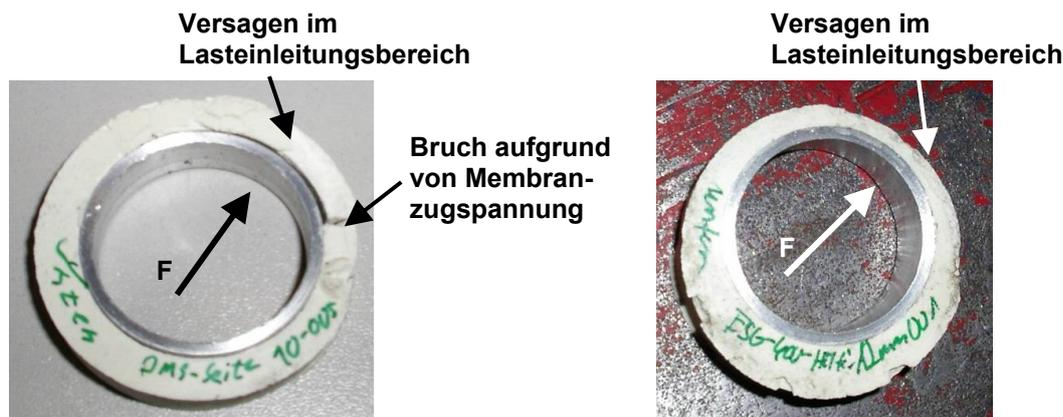
Bild 8.8: Ausgebaute Mörtelringe nach Versuchsdurchführung
