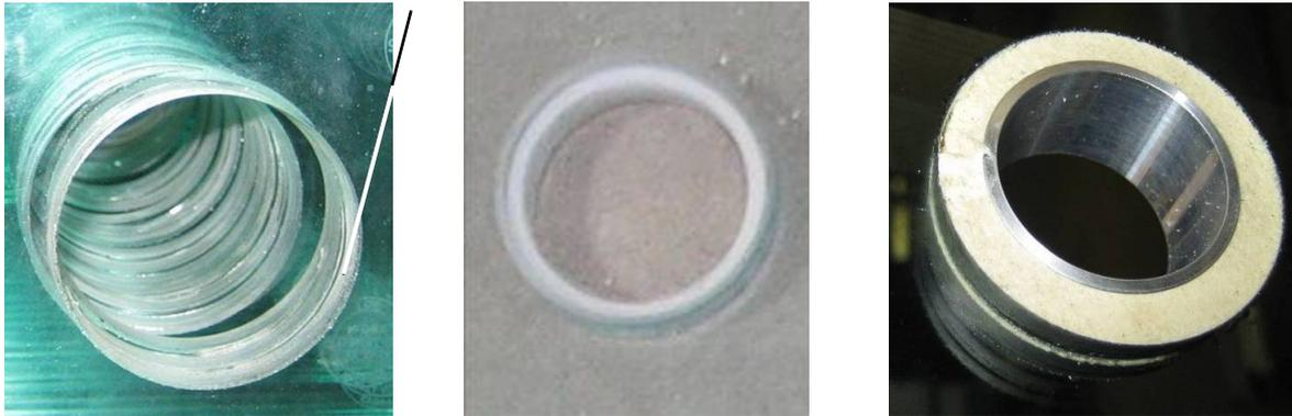
**Bild 2.7:** Versatz zwischen Einzelscheiben bei VSG im Bohrungsbereich (links), vorgefertigte Kunststoffhülse (Mitte), Vergussmaterial mit zusätzlicher Aluminiumhülse (rechts)
