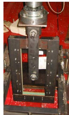
**Bild 8.1: Versuchsaufbauten der experimentellen Untersuchungen an N-Anschlüssen**
